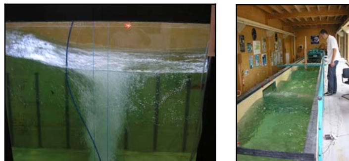
Figure 1. Modélisations en canal à houle (clichés BRLi)
