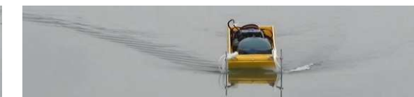
Tests avec injection de bulles sur le bord gauche: La vague d'étrave est complètement atténuée de ce côté.
