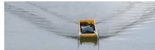
Tests sans injection de bulles: Deux vagues d'étrave bien symétriques sur chaque bord
