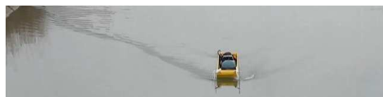
Tests avec injection de bulles sur le bord gauche: La vague d'étrave est complètement atténuée de ce côté.
