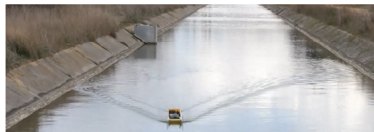
Tests sans injection de bulles: Deux vagues d'étrave bien symétriques sur chaque bord
